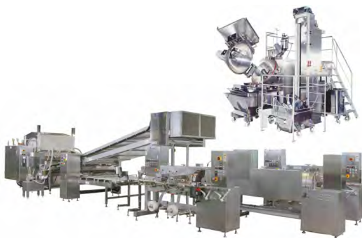
スーパーカニカマ製造装置(下)と、原料を高速処理するボールカッター
